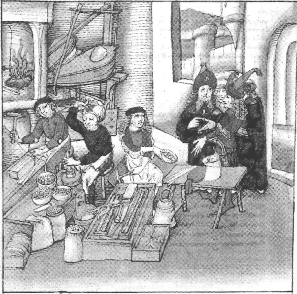
In hac officina nummi cuduntur ; præter varia instrumenta adspicitur furnus in quo ignis duobus follibus concitatur ad aurum fundendum.
